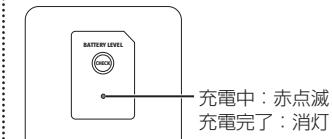
電池の充電中は、バッテリーの LED 表示が赤点滅します。
