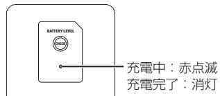
電池の充電中は、バッテリーの LED 表示が赤点滅します。
