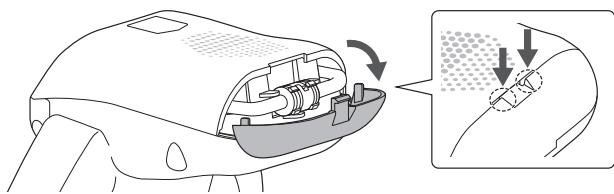
②コネクタの両側をつまみ、嵌合部を回しロックを解除させ引き抜きます。
