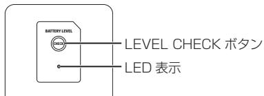
バッテリーの LEVEL CHECK ボタンを押し、電池残量を確認してください。
